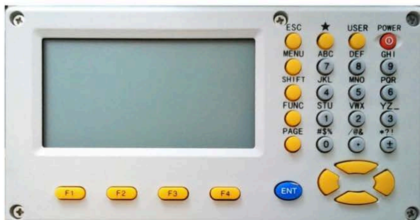
Рисунок 5 – Экран и клавиатура тахеометра RTS332
