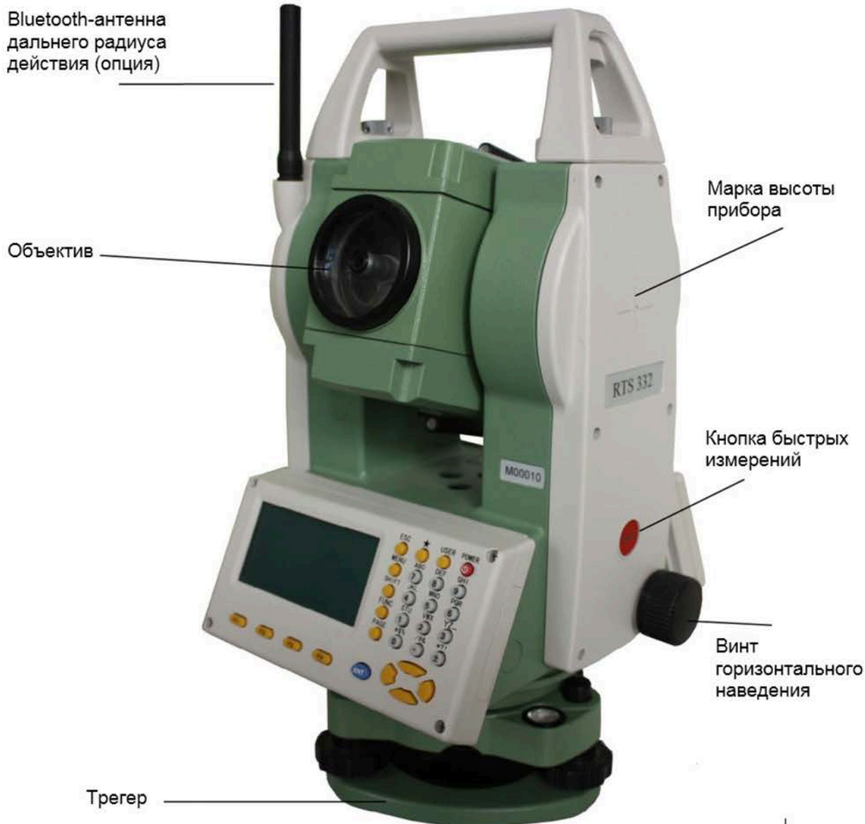
Рисунок 4 - Основные элементы тахеометра RTS332 (передняя часть)
