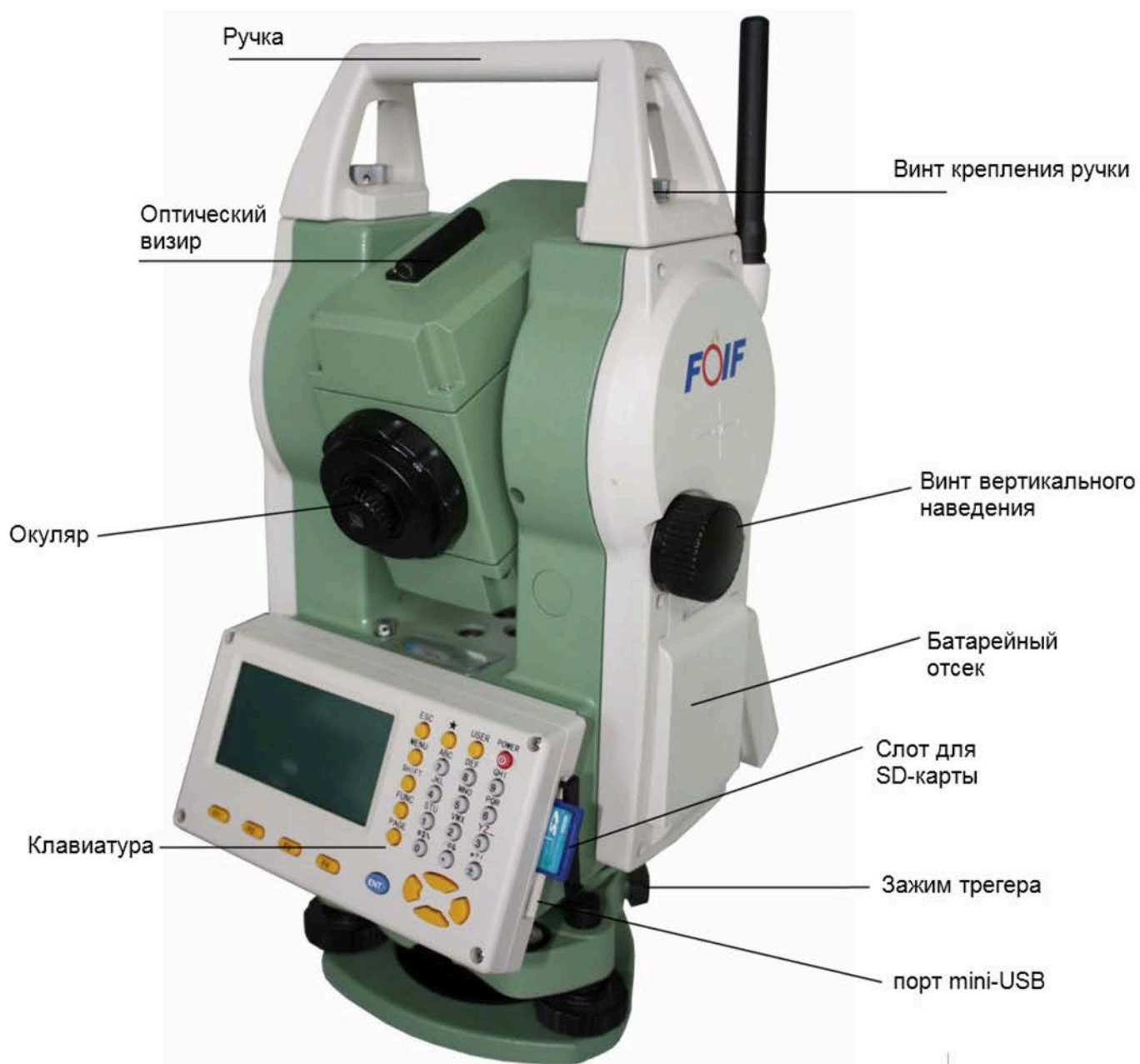
Рисунок 3 - Основные элементы тахеометра RTS332 (задняя часть)
