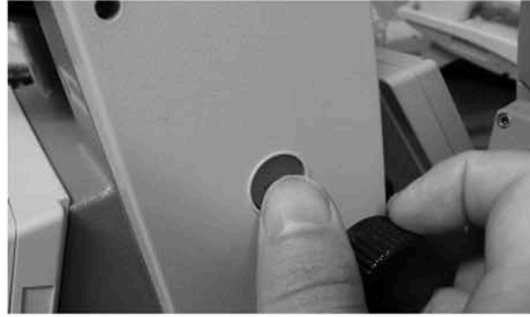
Рисунок 6 – Кнопка быстрых измерений тахеометра RTS332
